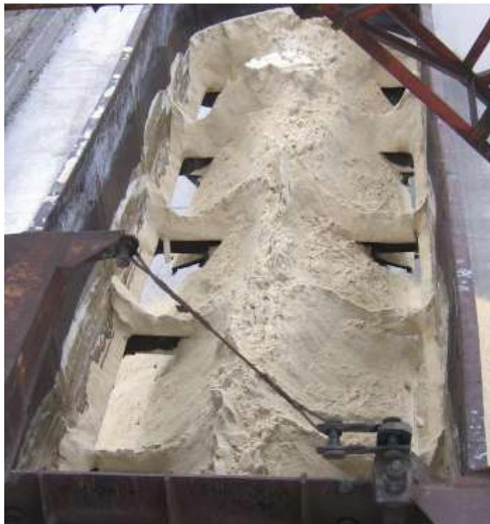
Рисунок 1 - Форма остатков песка в полувагоне после открывания крышек люков
