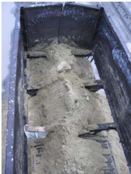
Рисунок 3 - Остатки формовочной смеси после вибрационной обработки полувагона
