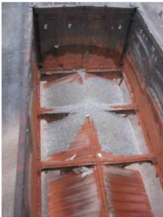
Рисунок 2 - Остатки щебня после вибрационной обработки полувагона
