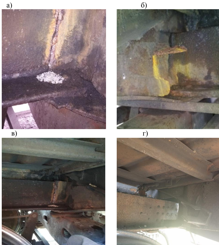
Рис. 1. Пошкодження рам вагонів а), в) тріщина в хребтовій балці; б) обрив зварювального шва; г) відрив шворневої балки
