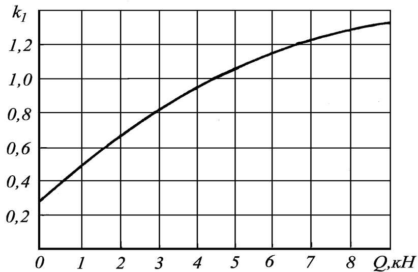
Рис. 1.5. Графік залежності коефіцієнта k_1 від опору баласту зміщенню шпали
