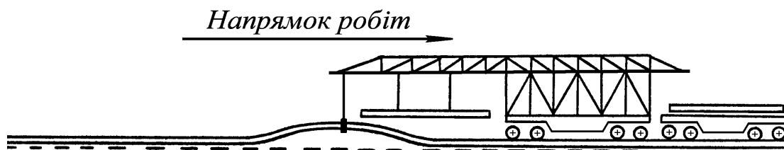
Рис. 2.13. Укладання зварних плітей безстикової колії з застосуванням навісного обладнання (спеціальної траверси) для укладального крана
