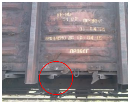
Рис. 1. Пошкодження запірних механізмів напіввагонів: а – відсутність закидки; б – заварена закидка
