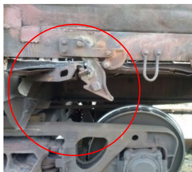
Рис. 1. Пошкодження запірних механізмів напіввагонів: а – відсутність закидки; б – заварена закидка
