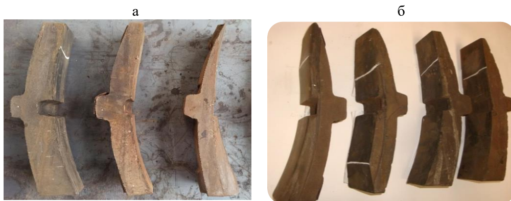
Рис. 1. Гальмові колодки з експлуатаційними явищами зносу: а) – «клиноподібного»; б) – «клинодуального»
