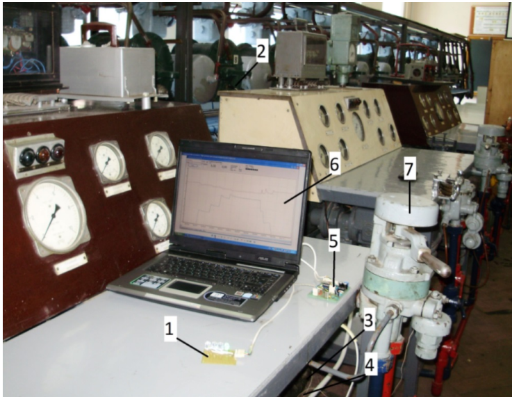
Рис. 3. Прототип системи дистанційного контролю гальм поїздів на базі випробувальної станції кафедри вагонів: 1 – світлова індикація вагона; 2 – датчик Д1 гальмового циліндра; 3 – датчик Д2 гальмової магістралі; 4 – датчик Д3 електропневматичного гальма; 5 – блок АЦП; 6 – ПК штабного вагона або АРМ ПТО; 7 – кран машиніста
