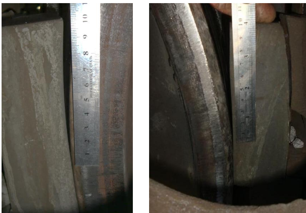
Рис. 1. Схема вимірювання довжини шкідливої стертості гальмової колодки, що утворилася в експлуатації
