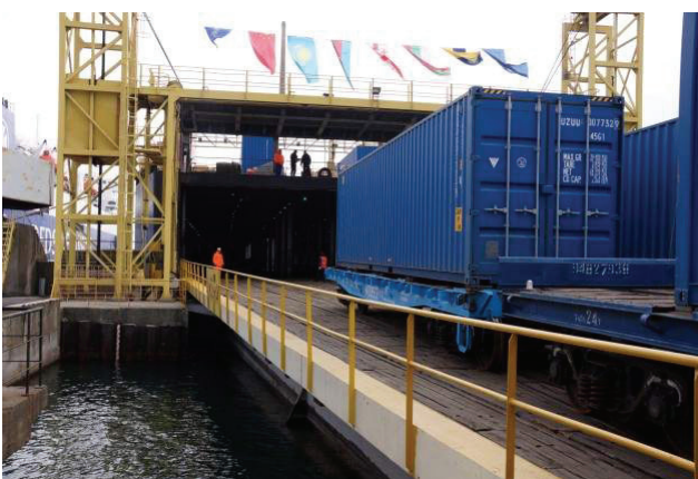
Рисунок 1 – Завантаження вагонів-платформ з контейнерами на залізничний пором
