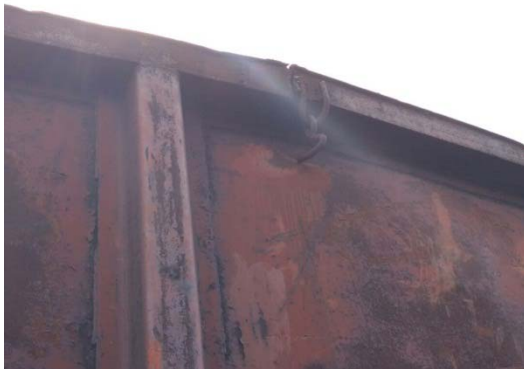
Рис. 2. Пошкодження верхнього обв'язування кузовів напіввагонів при розвантаженні грейферними ковшами: а – тріщини в верхньому обв'язуванні; б – розрив верхнього обв'язування
