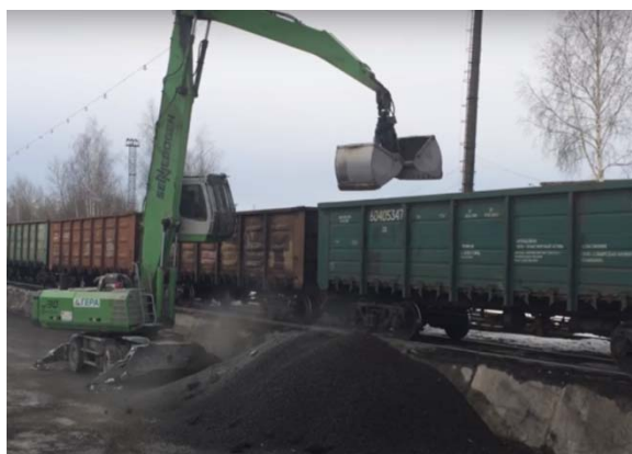
Рис. 1. Розвантаження вагона грейферним ковшем
