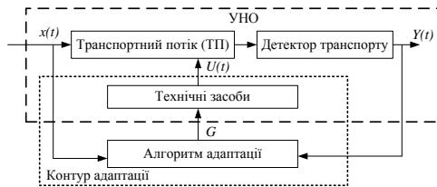
Рис. 2. Структурна схема адаптивної системи управління дорожнім рухом
