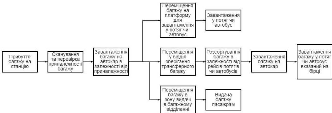
Рис. 2. Структурно-логічна схема обробки багажу при прибутті на станцію пересадки, у випадку сканування та перевірки багажу під час перевантаження з вагону на автокар
