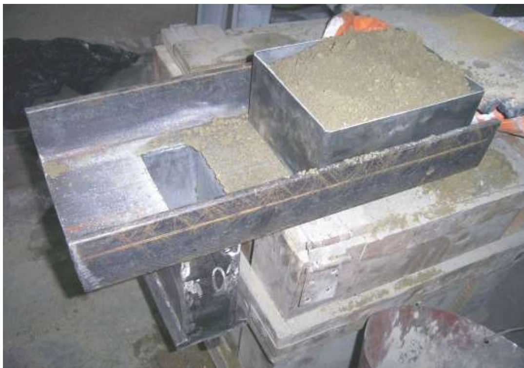
Рис. 3. Стенд для досліджень впливу вологості на густину й похибку засипки сировинної суміші у прес-форму
